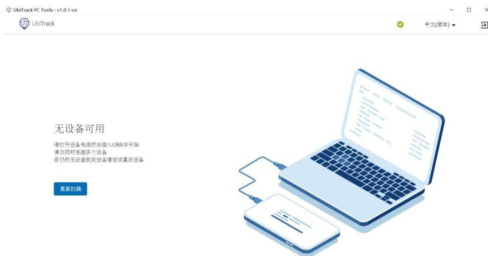
3. 标签通过数据线与电脑的 USB 端口相连接后，软件开始自动检测设备信息，如下图（**标签需要开启设备电源，且每次只能连接1个标签设备**）
