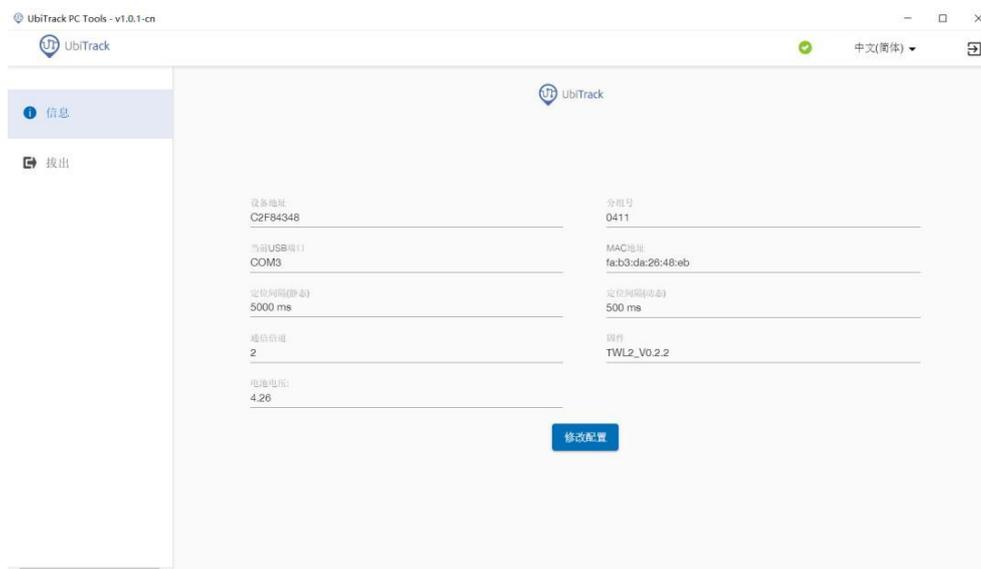
5. 扫描成功后，界面将显示标签的基本信息，如需修改标签的动/静态频率或同步标签时间（与电脑时钟同步），请点击【修改配置】后进入如下页面进行修改。若不需要，则点击【拔出】按键退出当前标签。
