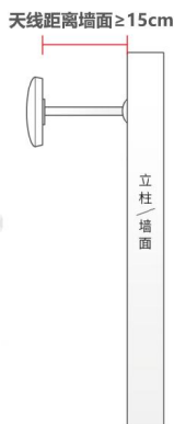
室内基站部署安装（墙面）
