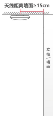
室内基站部署安装（屋顶）
